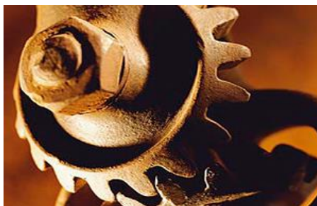
2-сурет. Жемірілу (коррозия)
